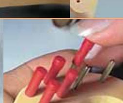
15 Jet-Hülsen über Jetpins stecken. Put sleeves over Jetpins.
